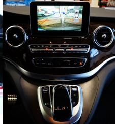
[Video Switch RFK und Front-Kamera mit Zeitschaltung. Schaltet nach dem R-Gang automatisch für 10 Sekunden auf die Frontkamera um.](#)
