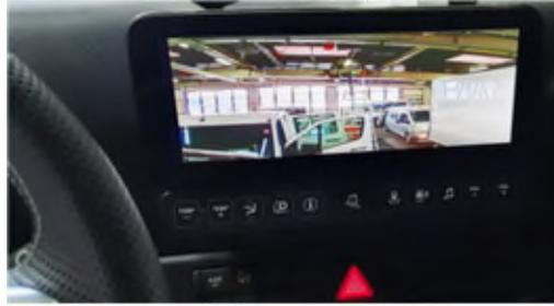
Mekra Rückfahrkamera für Actros 5 mit MBUX + Multimedia Cockpit Code J6B/J6C mit oder ohne RFK Vorrüstung Code J9J oder J9P. Kamerabild 16:9
