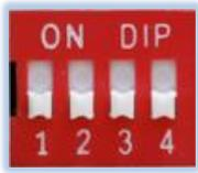
Jedem Kameraeingang ist der entsprechende Dip Schalter zugeordnet. Im Falle einer gewünschten gespiegelten Anzeige schalten Sie den Dip Schalter dieses Kanals auf "ON"(oben). Für die normale, ungespiegelte Anzeige muss die Einstellung "OFF" (unten) sein. Das "M" links oben im Display bestätigt die gespiegelte Display Einstellung des entsprechenden Kamerabildes.
