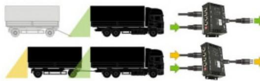
Automatische Kamera-Umschaltung auf Anhänger. RFK von LKW und Anhänger werden automatisch geschaltet, je nachdem ob der Anhänger angekoppelt ist oder nicht.
